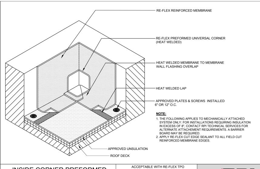
INSIDE CORNER PREFORMED FLASHING DETAIL
